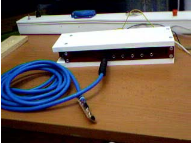
Şekil 3.2 8 Kanal PIC DataLogger
